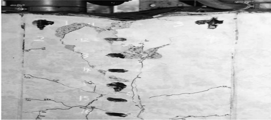
الشكل (3-1) شكل الإنهيار بالإنعطاف [3]
